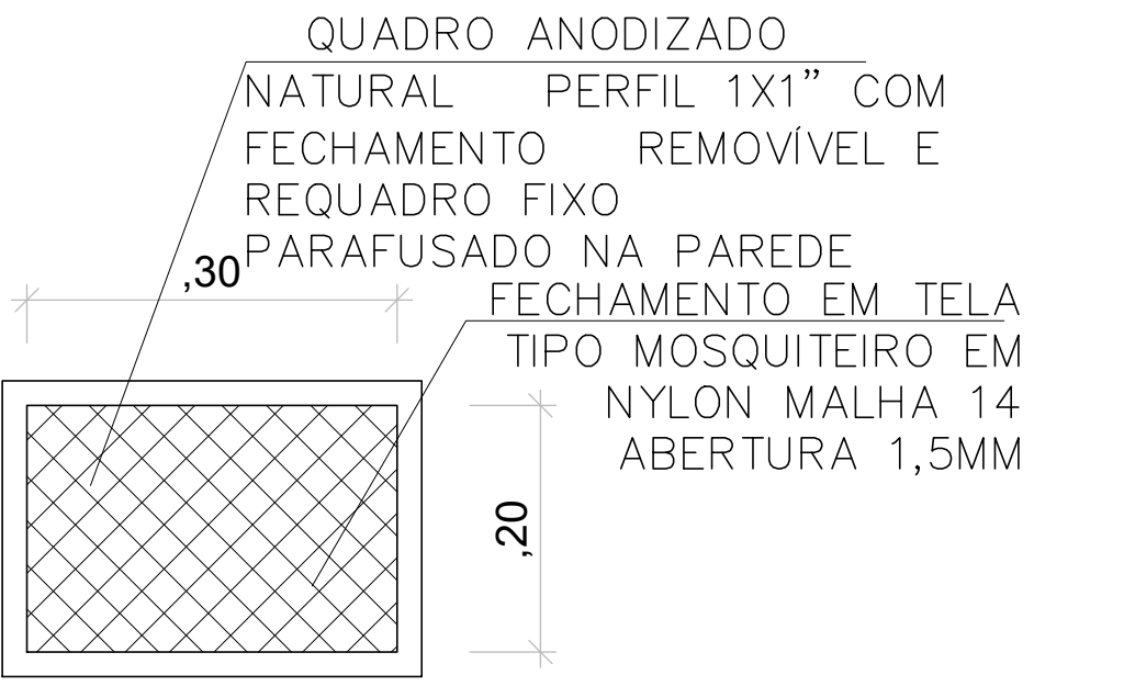
DETALHE 04 – VISTA EXTERNA ESC. 1/25 DETALHE DO QUADRO C/ TELA MOSQUITEIRO
